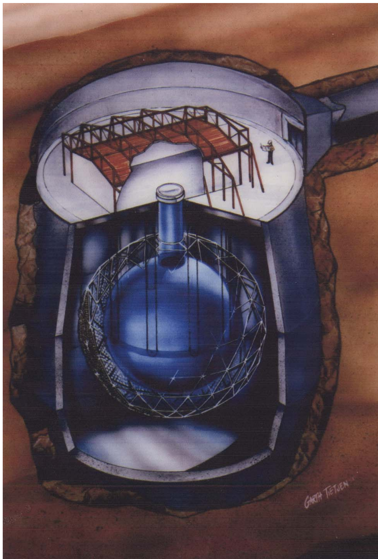
Рис. 4.73. Схема нейтринного детектора SNO лаборатории Садбэри
