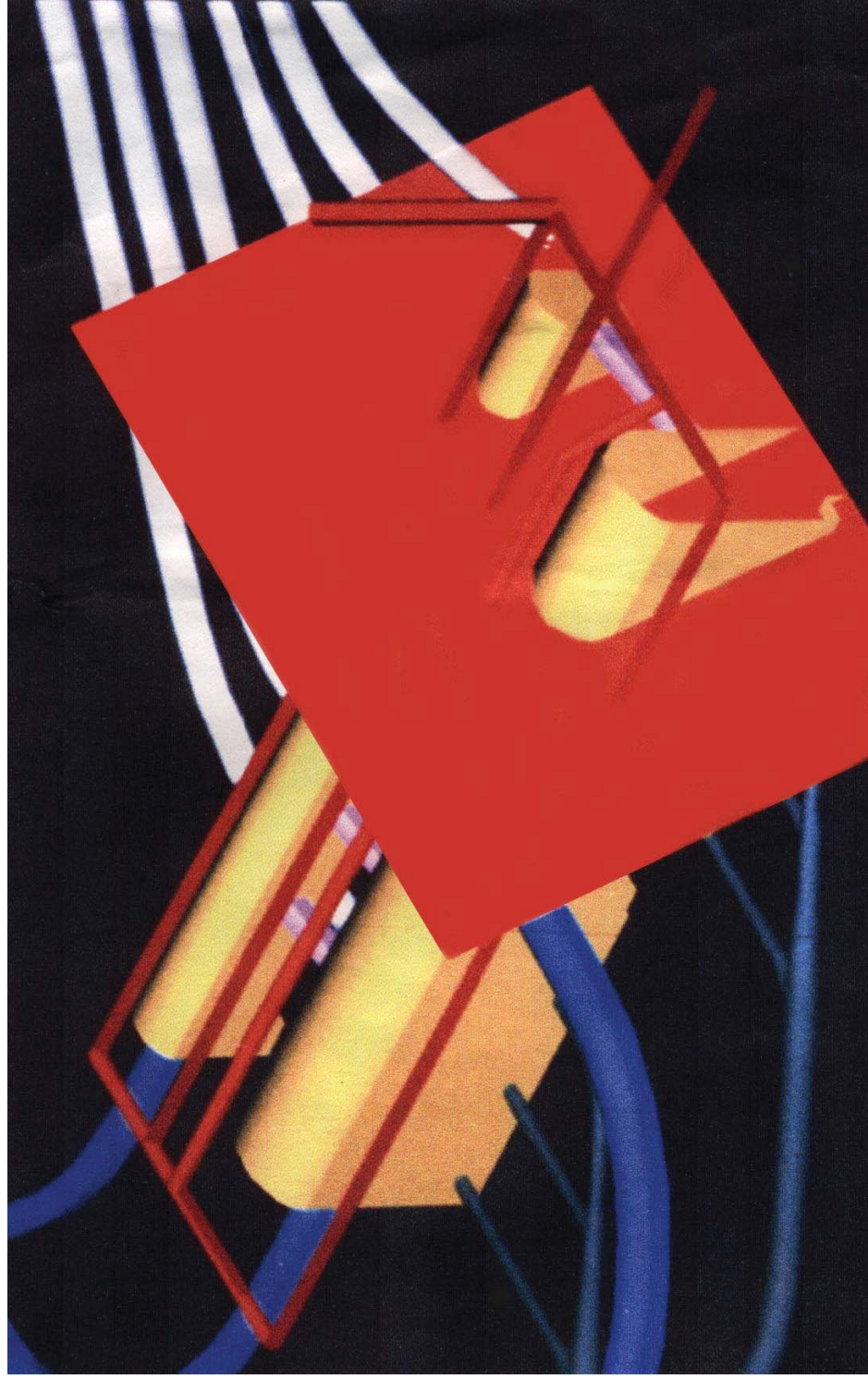
Рис. 1.6. Изометрическая модель расположения подземного комплекса Мингтан и нарушенных зон
