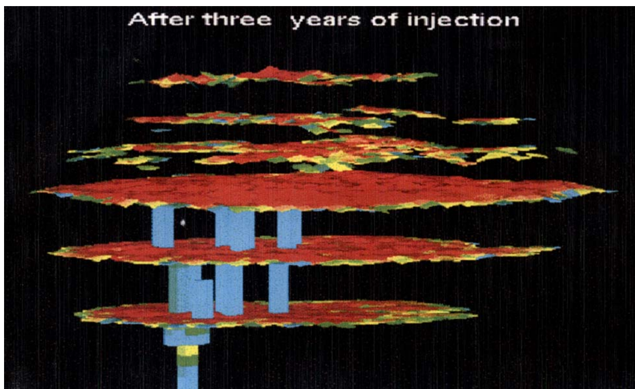
Рис. 1.7 Формирование бассейнов углекислого газа через три года после его закачивания в формацию Утсира
